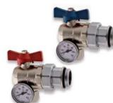
**350TK/1** Coppia di valvole a sfera a squadra a passaggio integrale con bocchettone dotato di O-ring, complete di termometri scala 0÷80°C. Misura disponibile 1".
