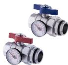
**305NTK/1** Coppia di valvole a sfera diritte a passaggio integrale con bocchettone dotato di tenuta O-ring, complete di termometro scala 0÷80°C. Misure disponibili 1" ed 1-1/4".
