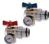
**350TK/1** Coppia di valvole a sfera ad angolo a passaggio integrale con bocchettone dotato di tenuta O-ring, complete di termometro scala 0÷80°C. Misura disponibile 1".
