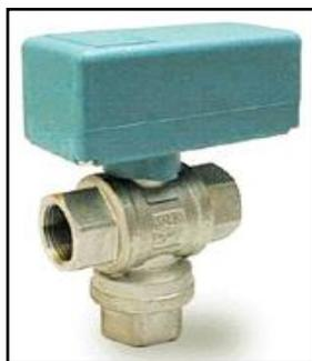
SERVOMOTORE REVERSIBILE PER VALVOLE A SFERA 2-3 VIE DEL TIPO A CONDENSATORE, TRENO DI INGRANAGGI IN ACCIAIO TRANNE I PRIMI DUE IN MATERIALE PLASTICO PER RIDURRE AL MINIMO IL RUMORE, CON COMANDO SPST MEDIANTE RELAY INTERNO, MICROINTERRUTTORE AUSILIARIO CON CONTATTI PULITI, CAVO DI ALIMENTAZIONE 6 X 0,50 MM<sup>2</sup> L = 100 MM, INVOLUCRO IN MATERIALE PLASTICO.
