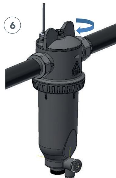
6 Chiudere lo scarico. Rimontare il tappo grigio di sicurezza. Rimontare il magnete. Girare la manopola in posizione open. Azionare la pompa. Infine dopo aver scaricato un po' di aria chiudere la valvola di scarico aria.
