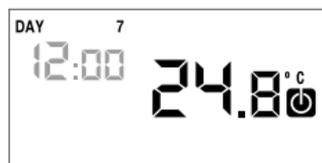
**Il cronotermostato rimane nella condizione di funzionamento spento fino a quando non viene inserita l'ora, garantendo comunque il mantenimento della temperatura di antigelo (6°C).**
