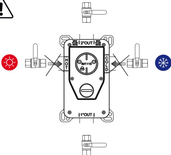
**RU** - пластиковая защитная заглушка выдерживает давление воды только необходимое для тестирования установки время. После тестирования не оставляйте установку под давлением до тех пор, пока **не** будут установлены внешние элементы.
