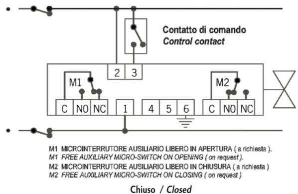
Morsetteria del servocomando con relé ( comando a due punti ) completa de i due micro ausiliari: il servocomando è raffigurato nelle condizioni di apertura e di chiusura.
