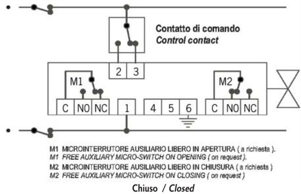
Morsetteria del servocomando in versione senza relé ( comando a tre punti ) completa dei due micro ausiliari raffigurato nelle posizioni di Aperto e Chiuso.
