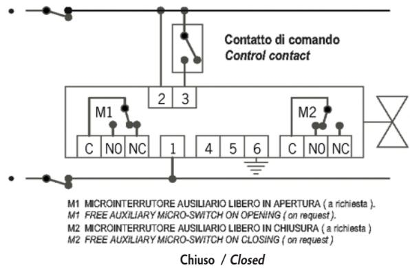
Morsetteria del servocomando con relé ( comando a due punti ) completa de i due micro ausiliari: il servocomando è raffigurato nelle condizioni di apertura e di chiusura.
