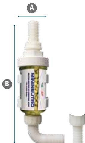
La condensa prodotta dalle caldaie a condensazione risulta acida, ed è quindi buona norma provvedere alla sua neutralizzazione (per evitare inquinamenti e corrosione dei materiali) e la nostra miscela di materiali inerti agisce innalzando il valore del pH.
