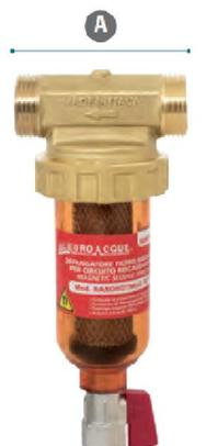
Defangatore filtro magnetico, dotato di sistema di scarico per espulsione del filtrato. Attacchi combinati femmina 3/4" e maschio 1". Uso riscaldamento/condizionamento (90°C).
