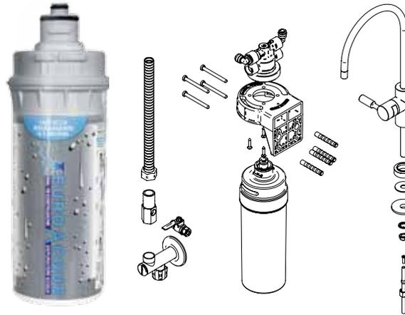
Cartuccia a struttura composta adatta al trattamento di acque potabili conforme al DM 25/2012 ed al DM 174/2004. La cartuccia è del tipo monouso realizzata con la tecnologia del carbon block addizionato con argento in grado di esplicare un'azione batteriostatica. La cartuccia è in grado di rimuovere o ridurre odori e sapori indesiderati, torbidità, cloro, con grado di filtrazione nominale pari a 0,5 micron.
