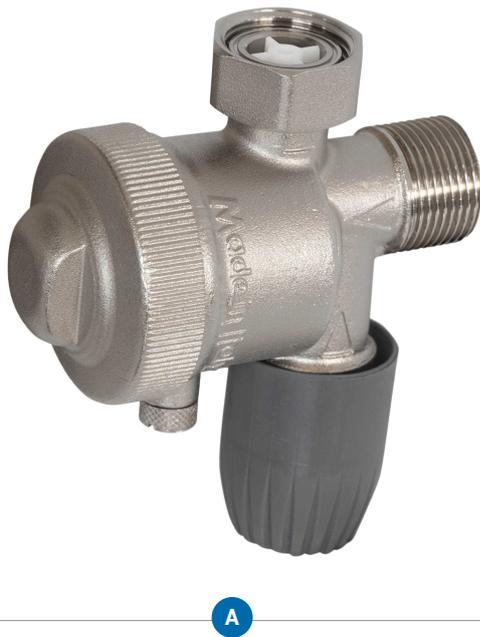
**DESCRIZIONE.** HIPPO STOP OTTONE è il mini defangatore filtro magnetico con valvola di chiusura impianto incorporata e valvola di non ritorno. Per installazioni facili, rapide e salvaspazio (in meno di 4 cm di interasse) sotto le caldaie a condensazione.
