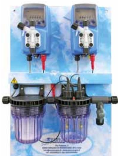
Pannello assemblato per la regolazione automatica e l'analisi del potenziale redox (Cloro) e valore pH con segnalatori valore a led. Completa di strumenti per la misurazione e il controllo del Cloro, e del Ph, portaelettrodo a deflusso, filtro. Il sistema è dotato di n°2 pompe dosatrici digitali integrate per dosaggio sanitizzante e regolatore ph. Sono compresi n°2 serbatoi per reagenti.
