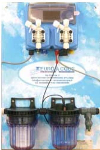
Pannello assemblato per la regolazione automatica e l'analisi del potenziale Redox (Cloro) e valore pH con display digitale retroilluminato multifunzione (multiparametro). Completa di strumenti per la misurazione e il controllo del potenziale Redox, e del Ph, portaelettrodo a deflusso, filtro. Il sistema è dotato di n°2 pompe dosatrici digitali integrate per dosaggio sanitizzante e regolatore Ph. Sono compresi n°2 serbatoi per reagenti.
