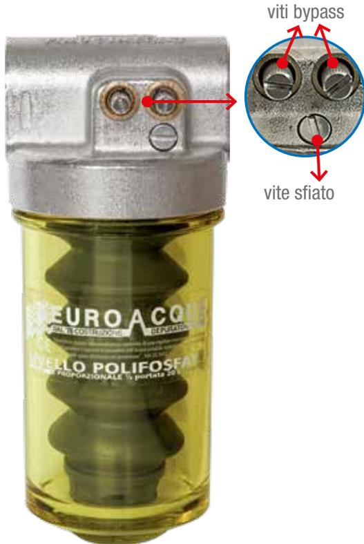
**DESCRIZIONE.** Dosatore con attacchi a squadra, codolo collegamento, valvola di sfiato, by-pass e regolatore consumo. Permette installazioni in spazi limitati come la dima delle caldaie murali.
