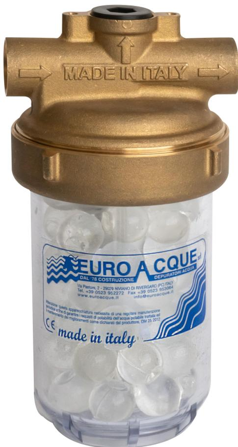
**DESCRIZIONE.** Inibitore delle incrostazioni e della corrosione per il trattamento dell'acqua potabile completo di prima carica e di pre+prefiltro. La carica di silicofosfati agisce con una doppia azione: anticalcare + anticorrosiva aiutando nel prevenire sia le incrostazioni date dal calcare che la corrosione dei metalli.
