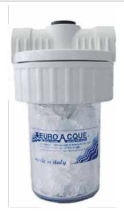
Dosatore di Polifosfato a cristalli completo di tubo pescaggio, distributore circolare e carica cristalli di Polifosfato. I dosatori in plastica non devono essere installati in luoghi soggetti a sbalzi di pressione. PN7.
