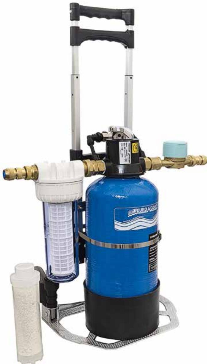
**DESCRIZIONE.** Addolcitori per carico impianti completi di contatore, filtro multifunzione (sedimenti + ricarica addolcitore) e attacchi ad innesto rapido. Dotati di mix (miscelatore durezza). Solo la versione "trolley" è dotata di carrello per il trasporto (versione portatile).
