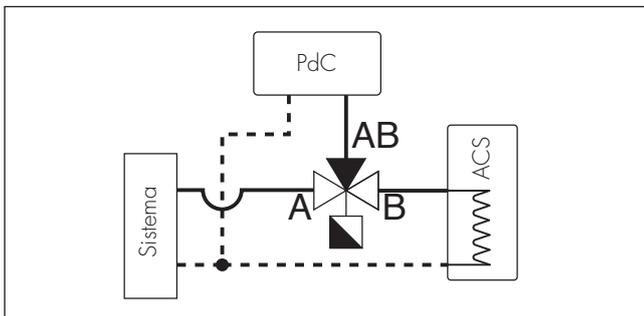
2. La valvola va installata con l'asta di comando in posizione orizzontale oppure verticale, **mai in posizione rovesciata**.
