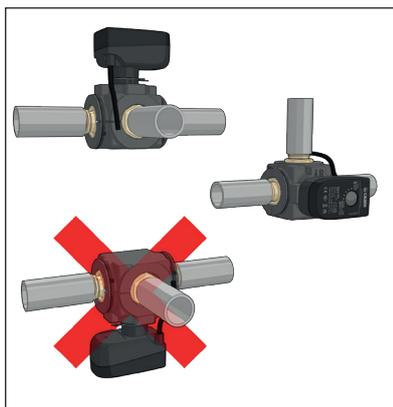
3. Il servomotore può essere montato sul corpo valvola nelle due posizioni indicate. Il fissaggio è effettuato mediante un fermo elastico in acciaio inox.
