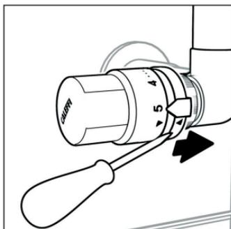
1. Ruotare la manopola in posizione tutta aperta (Pos. 5). Con l'aiuto di un cacciavite sganciare la ghiera spingendola verso il corpo valvola fino a battuta.
