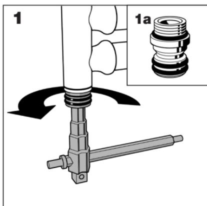
2. Dopo avere effettuato le operazioni di collegamento della valvola/detentore alle tubazioni, lubrificare il doppio O-Ring del codolo (1a) con lubrificante siliconico ed accoppiarlo alla valvola con una operazione di innesto a pressione fino a battuta. Sollevare leggermente il termoarredo per poter agevolare l'operazione.
