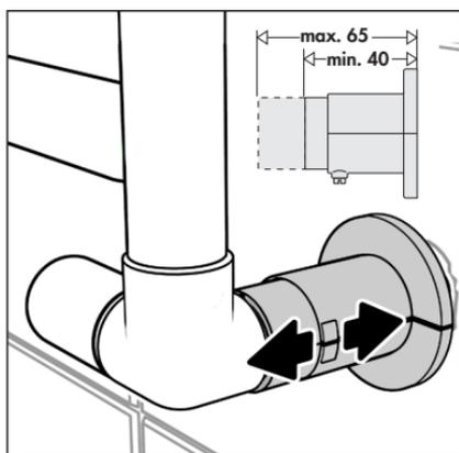
3. Fissare le due parti del copritubo nella zona inferiore non visibile con la vite (taglio cacciavite per le valvole termoarredo attacco laterale, a brugola per le valvole termoarredo con attacco centrale) fornita in confezione fino a battuta.
