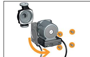
5. Assemblare il gruppo come in figura, serrando completamente le calotte mobili, facendo attenzione a posizionare correttamente le guarnizioni presenti.
