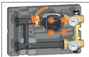
Nelle versioni con circolatore EVOSTA2 ruotare la parte elettronica della circolatore, svitando le quattro viti indicate dalle frecce e ruotando il corpo di 180° in senso orario. Senza eseguire questa operazione, non è possibile reinserire il gruppo nella coibentazione.
